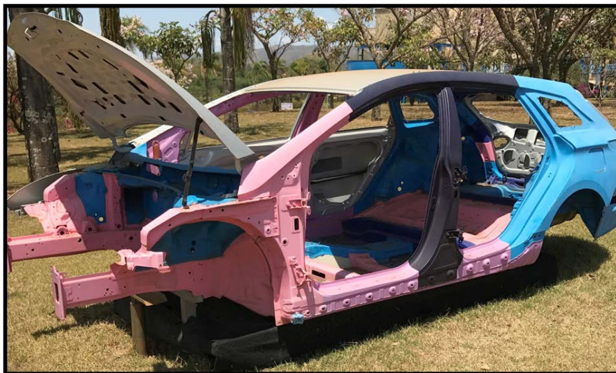
Fotografia 1. Estrutura de um veículo automotor exposta no pátio da CBMM, com identificação do emprego do nióbio na cor rosa.
