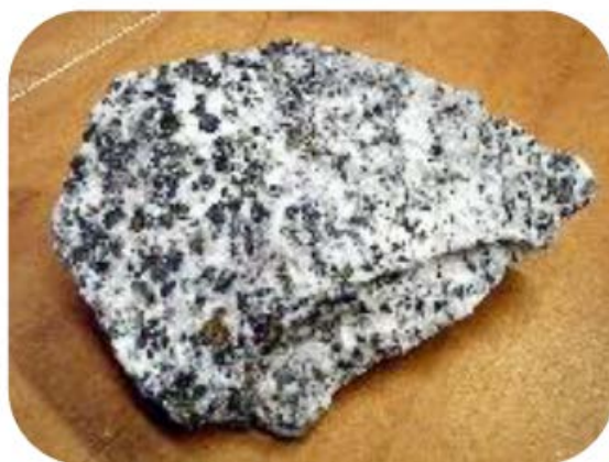
Figura 1. Carbonitativo. Carbonatitos são rochas magmáticas constituídas por mais de 50% de minerais carbonatados e enriquecidos em elementos como Terras Raras e Nióbio.
